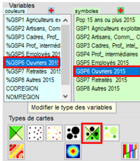
Figure n°51 : Le choix d'une variable dans la liste couleurs et d'une seconde variable dans la liste symboles et du type « carte en cercles proportionnels sur surfaces colorées ».
